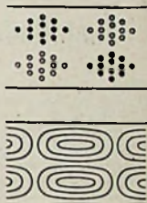
Fig. 11. TE 2,0 golf. Boven het momentale elektrische, onder het magnetische veld.
